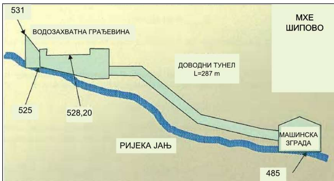
Слика бр. 56 Основни конструктивни елементи МХЕ Шипово
