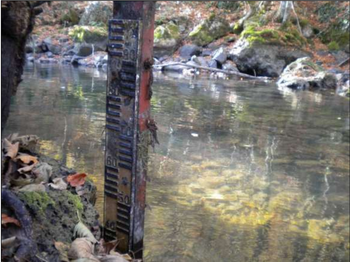
Слика бр. 14 Водомјер на ријеци Јањ, постављен непосредно низводно од планиране локације за изградњу водозахвата МХЕ Шипово
