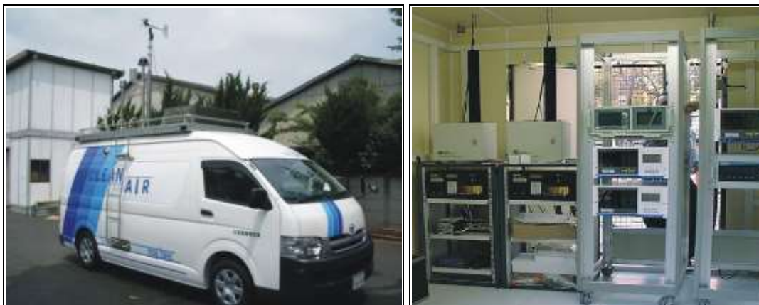
Слика бр. 61 Примјер Мобилне аутоматске мјерне станице
