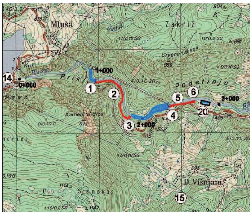
Slika 14: Položaj planiranih objekata MHE Gradina i MHE Modri vir (1 – brana MHE Gradina; 2 – trasa cjevovoda MHE Gradina; 3 – strojarnica MHE Gradina; 4 – brana MHE Modri vir; 5 – trasa cjevovoda MHE Modri vir; 6 – strojarnica MHE Modri vir; 14 – brana i akumulacija HE Rama; 15 – dovodni tunel HE Rama; 20 – postojeći ribnjak)
